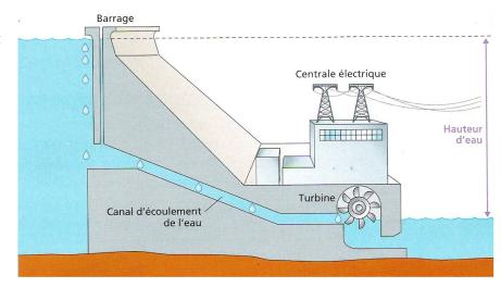
S'il n'y avait pas de différence de hauteur entre la turbine et le barrage, alors l'eau ne coulerait pas et la centrale électrique ne fonctionnerait pas.
